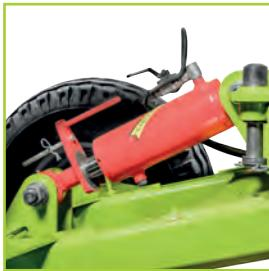
Регулировка глубины обработки этой модели плуга выполняется без использования инструментов и резьбовых соединений, что полностью исключает коррозию и задиры резьбы.
