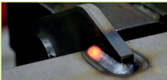
Сварка металлоконструкций любой сложности в среде защитных газов MIG/MAG обеспечивает высокую производительность и качественное соединение.
