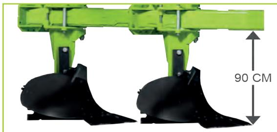
Высота от рамы плуга до плоскости лемехов составляет 90 см, что позволяет работать без забивания плуга на полях с большим количеством растительных остатков.
