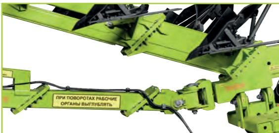
Модульная рама позволяет изменять количество корпусов плуга, тем самым без затрат адаптироваться к тяговым возможностям трактора и почвенным условиям.
