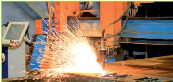
Станок газо-плазменной резки обеспечивает высокий уровень точности обработки и резки листового металла.
