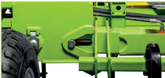
Рама культиватора состоит из 5 шарнирно сочлененных секций, которые имеют большой диапазон перемещения как вверх, так и вниз. Это обеспечивает наиболее полное копирование рельефа поля, и как следствие, постоянство глубины обработки.
