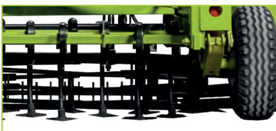
Все рабочие органы установлены с перекрытием, что гарантирует сплошную обработку почвы без пропусков.
