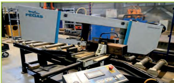
Ленточнопильные станки прекрасно режут круглые, фасонные и трубные заготовки из стали (включая нержавеющую и инструментальную)
