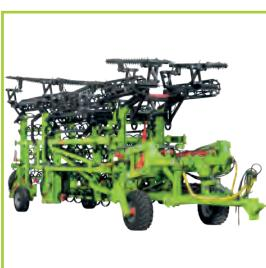
Ширина в транспортном положении 2,5 м. значительно упрощает маневрирование, и допускает транспортировку по дорогам общего пользования.
